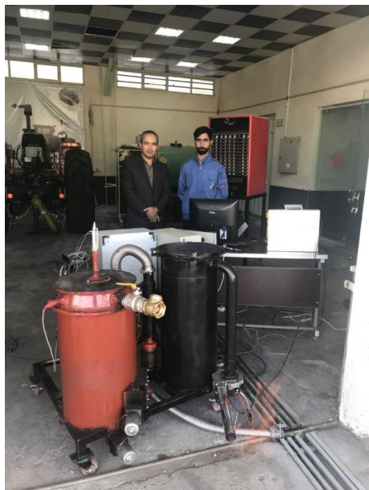
تصویر سامانه گازیساز زائادات باگاس در پژوهشگاه نیرو
